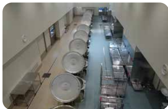
1つの釜で1000食のおかずを調理できる「蒸気回転釜」で味噌汁、カレー、スープなど調理する
